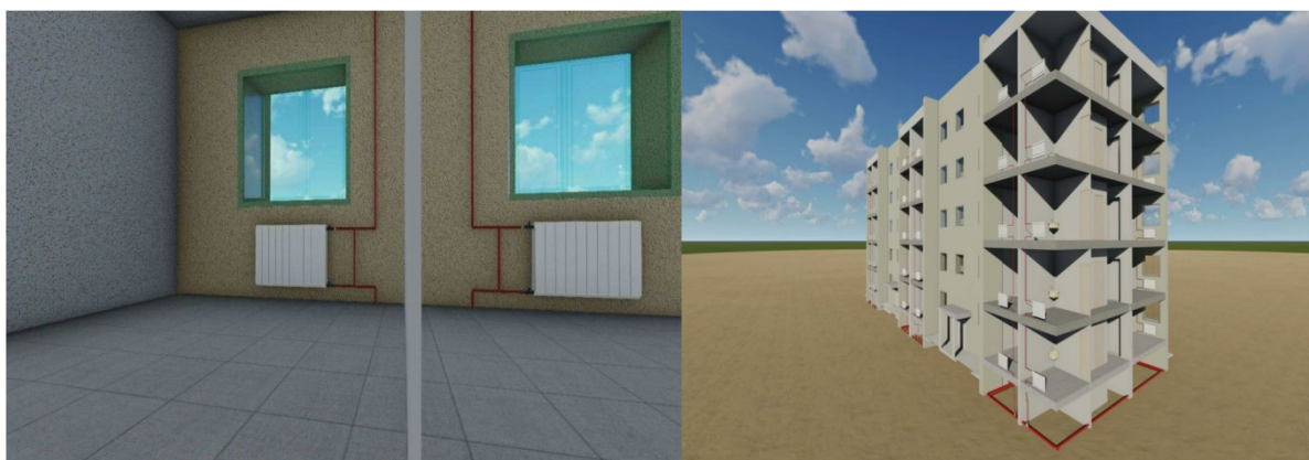
Рис. 10. Система отопления в модели здания.
